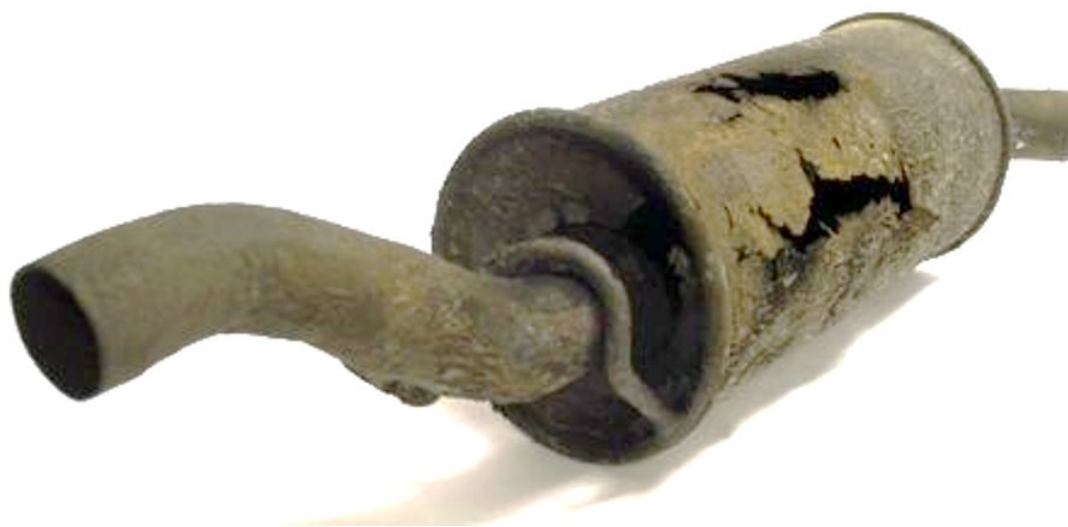
Рисунок 2. Резонатор автомобиля разрушенный в следствии газовой коррозии.
