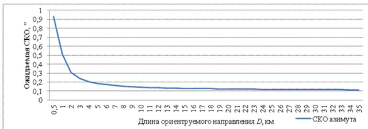
Рисунок 1. Ожидаемые СКО определения геодезических азимутов в зависимости от расстояния D между точками установки антенн АП КНС, приведенного на плоскость горизонта.
