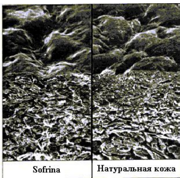
Рисунок 1. Внутренняя структура синтетической кожи нового поколения марки «Sofrina» и натуральной кожи.
