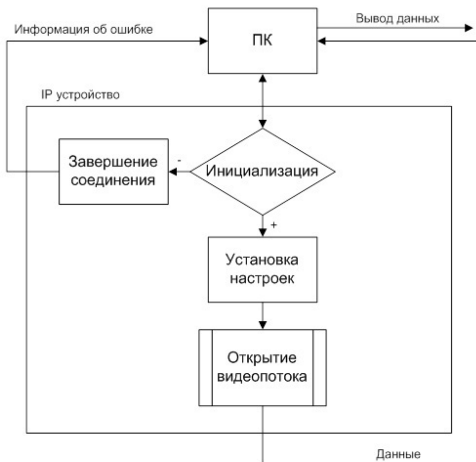
Рисунок 1. Структурная схема взаимодействия IP устройства с компьютером
