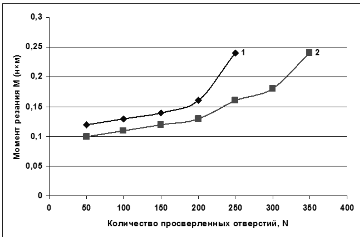
Рисунок 2. Зависимость момента резания M от количества просверленных отверстий N : 1 — сверло, необработанное импульсным магнитным полем; 2 — сверло, обработанное импульсным магнитным полем
