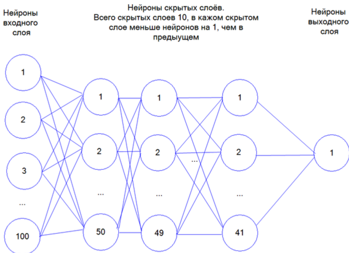
Рисунок 7. Схема нейронной сети разработанной системы (Состоящая из одного входного слоя, содержащего 100 нейронов; 10 скрытых слоёв, содержащих в себе 50 нейронов в первом входном слое и 41 в последнем; одного выходного слоя). Частный случай.
