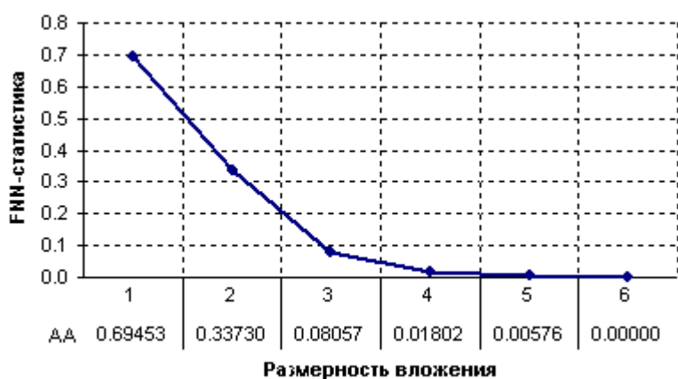
Рис. 6. Зависимость отношения числа ложных соседей ко всем соседям от размерности вложения для ряда AA
